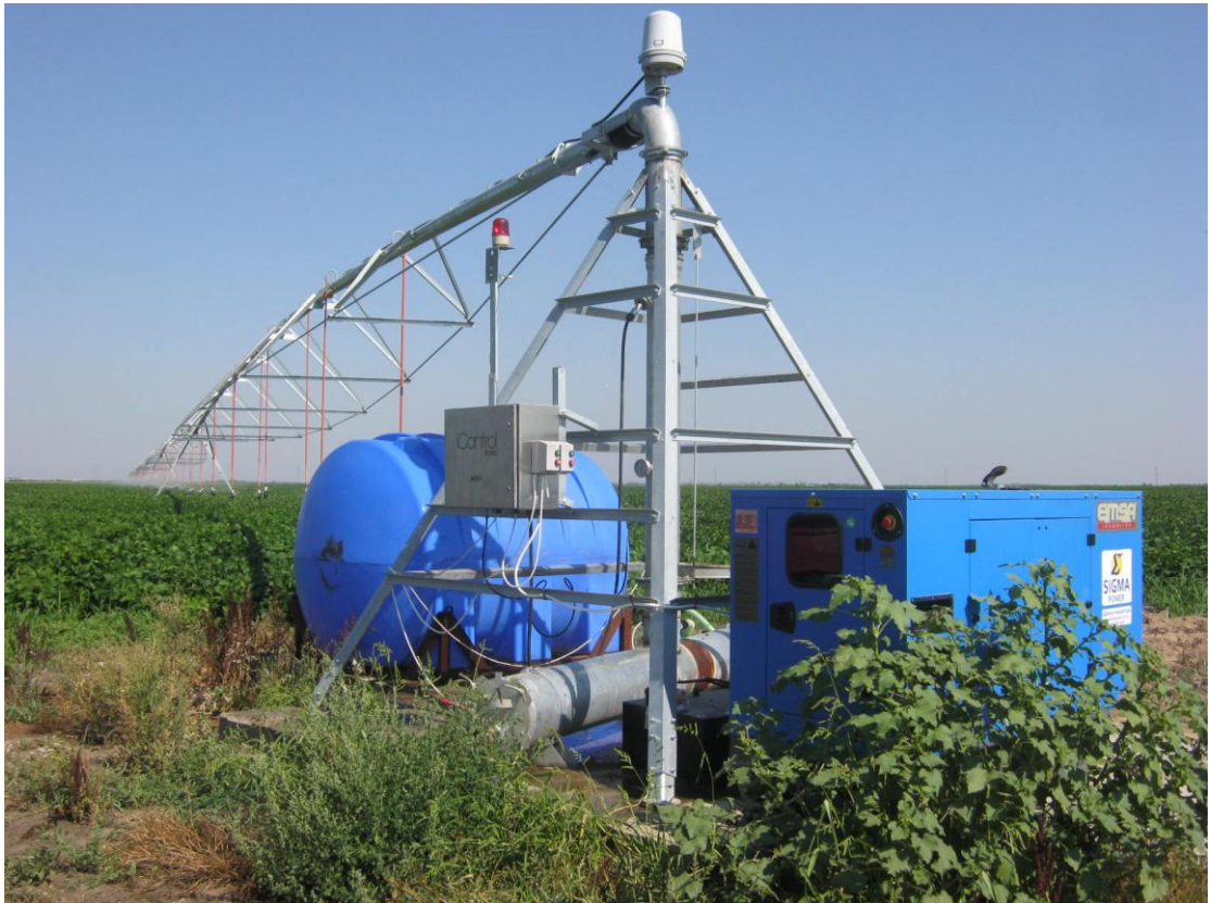
Рис. 1 Дощувальна машина «Western-428 CP 600» F52.17 в роботі
